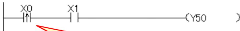
Если контакт «X0» (X0) переключается из состояния OFF (ВЫКЛ.) в состояние ON (ВКЛ.), он на время одного цикла остается в состоянии ON (ВКЛ.).
